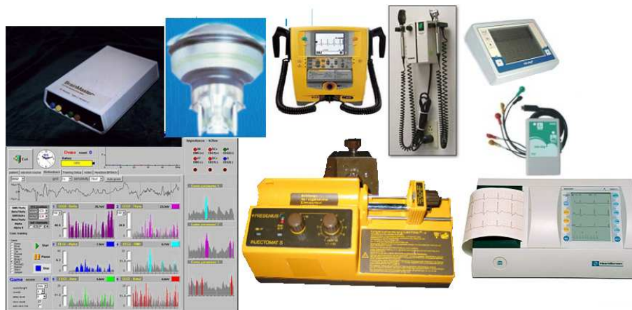
Rys. 1.12: Przykłady aparatury medycznej: urządzenia i oprogramowanie do EEG, wzmacniacz obrazu, pompa infuzyjna, urządzenia do defibrylacji i EKG (źródło: Internet).
