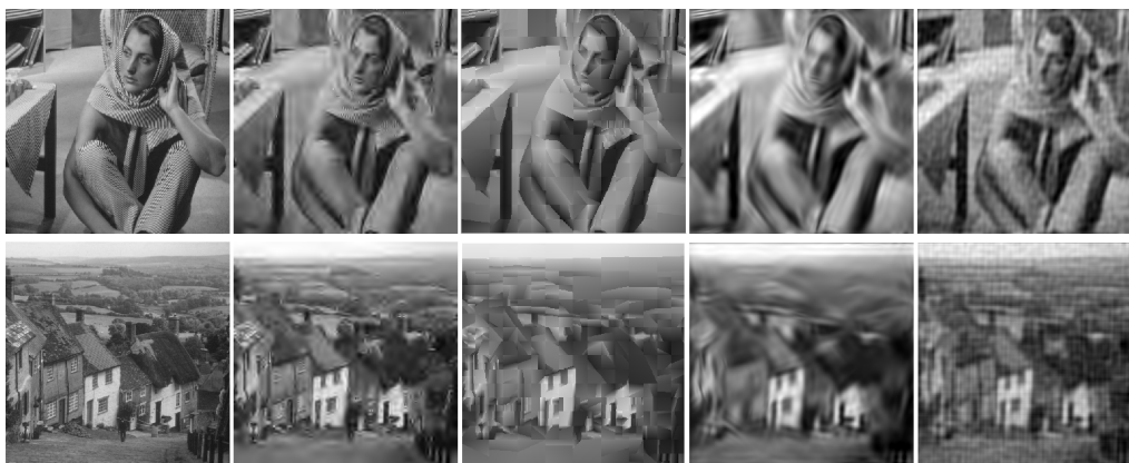
Rysunek 1.6: Efekty opisu dwóch obrazów testowych (barbara i goldhill) za pomocą upakowanej reprezentacji; od lewej kolejno obrazy źródłowe o rozmiarze 512 \times 512 \times 8 bitów oraz ich przybliżenia z 13,6% współczynników obrazów, uzyskanych za pomocą bazy falkowej, wedgetowej (kliników), curveletowej (krzywek) oraz fourierowskiej.
