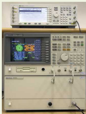
Laboratorium radiokomunikacji: stanowisko do badań telefonów GSM (u góry), stanowisko do generacji i analizy sygnałów z zaawansowanymi modulacjami cyfrowymi (z lewej).
