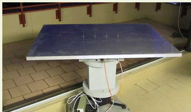
Antena inteligentna sterowana algorytmem genetycznym (2004).
