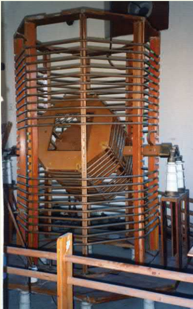
Układ dostrajania anteny nadajnika długofalowego dla stacji w Radomiu (ok. 1988 r.).
