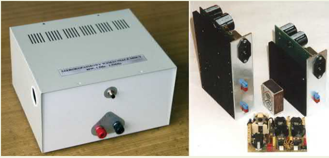
Szerokopasmowy liniowy wzmacniacz mocy 40W-1,5Hz ...1,5MHz (2001) (z lewej) i wysokosprawne zasilacze napięcia stałego z przetwornicami rezonansowymi klasy DE (2000) (z prawej).
