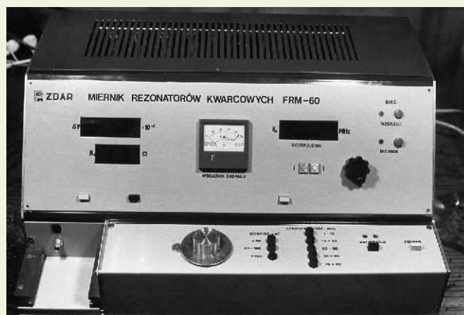
Przykład urządzenia opracowanego pod koniec lat 70. w IR i wdrożonego w zakładzie ZDAR - miernik parametrów rezonatorów kwarcowych FRM-60.
