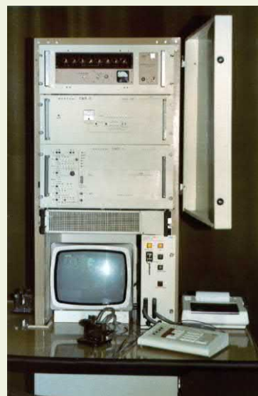
System CMS-3 do produkcyjnych pomiarów rezonansu głównego i rezonansów niepożądanych rezonatorów kwarcowych (1986).
