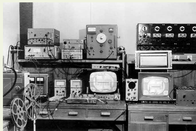
Stanowisko do badań możliwości przesyłania obrazów telewizyjnych bez sygnału synchronizacji - symulatorem „żywego” obrazu jest projektor filmowy (ok. 1971).
