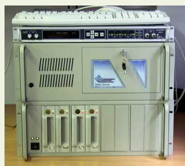
Laboratorium telewizji - Wideoserwer - źródło sygnału MPEG-2 do sieci telewizji kablowej.
