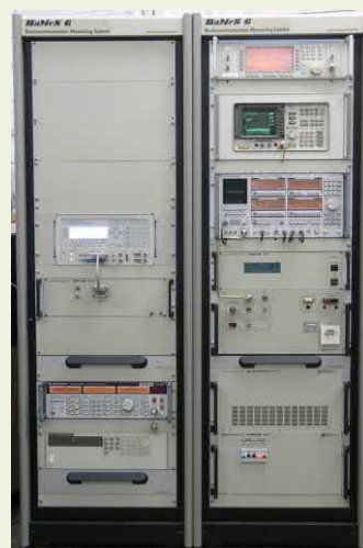
System do pomiaru urządzeń radiokomunikacyjnych FM RaMeS-6 (1995, rozbudowa oprogramowania - 2004).
