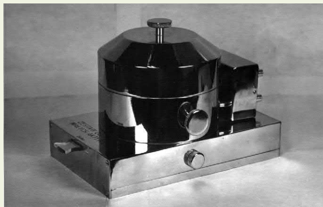
Zestaw do pomiaru małych aktywności, skonstruowany w Zakładzie Elektroniki Jądrowej, produkowany przez Zakład Doświadczalny ZDAR.
