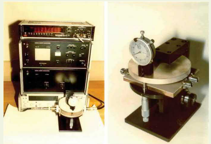
System do pomiaru parametrów materiałów w paśmie mikrofalowym i jedna z głowic pomiarowych.
