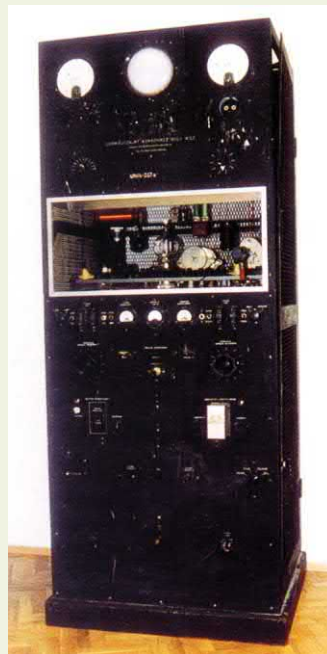
Doświadczalny wzmacniacz mocy wielkiej częstotliwości zbudowany w latach 50. w obudowie nadajnika z lat 20.
