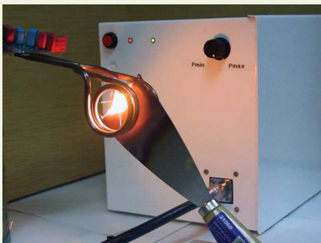
Nagrzewnica indukcyjna 1,5KW/1MHz z wysokosprawnym wzmacniaczem mocy klasy DE.
