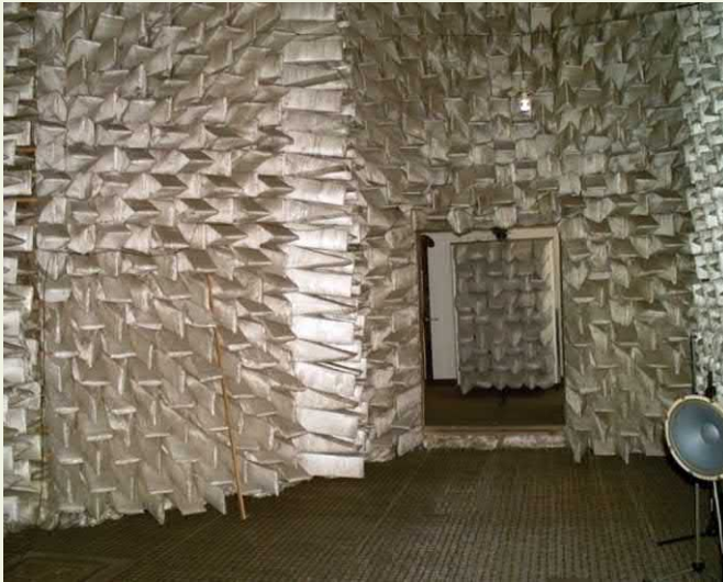
Komora bezechowa w nowym Gmachu Wydziału Łączności - najważniejsze pomieszczenie badawcze Zakładu.
