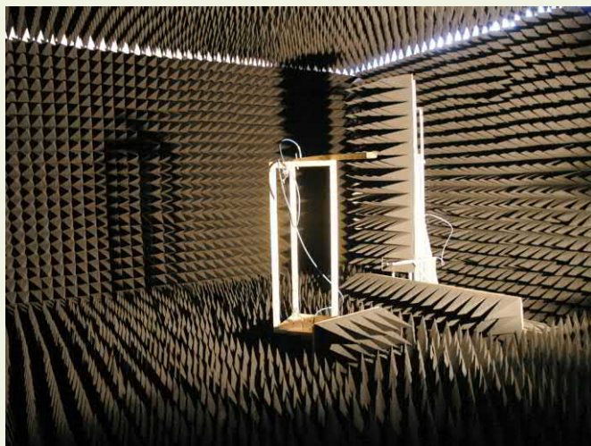
Laboratorium techniki antenowej - wnętrze komory bezodbiciowej.
