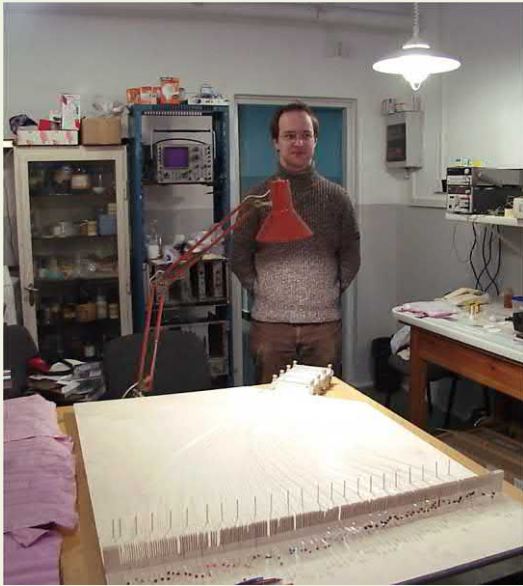
Montaż detektora promieniowania opartego na zastosowaniu światłowodów scyntylacyjnych dla eksperymentu COMPASS w CERNie - Pracownia Detekcji i Spektrometrii - na zdjęciu M. Ziembicki - doktorant.
