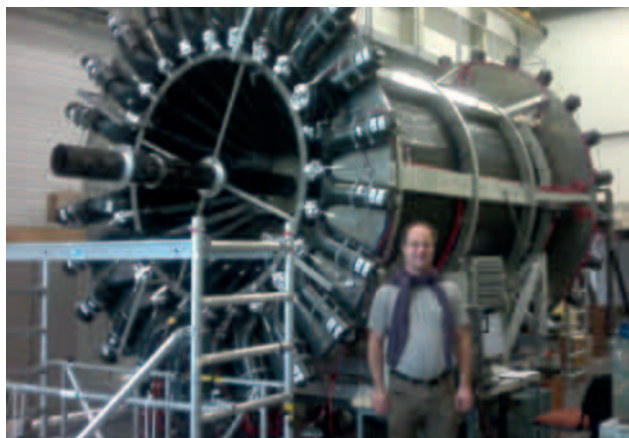
Detektor protonów odrzutu (RPD) w eksperymencie COMPASS w CERN w trakcie montażu – na zdjęciu Marcin Ziembicki, 2012
