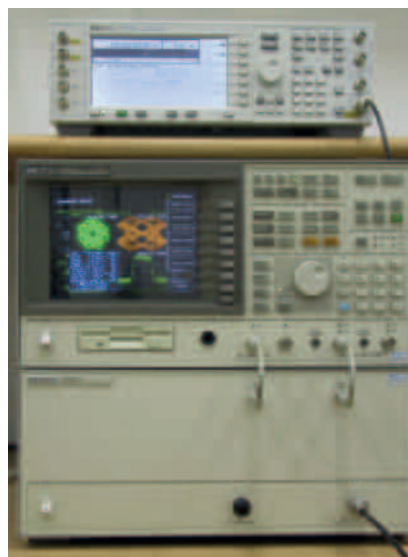
Laboratorium radiokomunikacji – stanowisko do generacji i analizy sygnałów z zaawansowanymi modulacjami cyfrowymi
