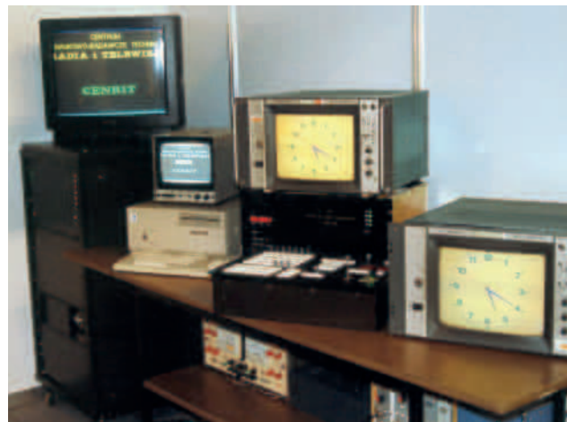
Syntetyzer napisów telewizyjnych, opracowany w ZTV IR, a wdrożony do produkcji w Centrum Naukowo-Badawczym Techniki Radia i Telewizji (CENRiT) w Warszawie, używany w licznych ośrodkach telewizyjnych w Polsce i krajach sąsiednich (1989 r.)
