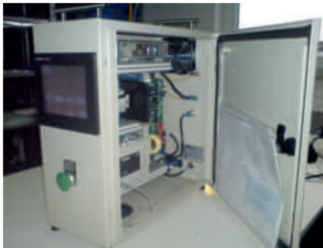
Przemysłowy układ do nagrzewania indukcyjnego ze wzmacniaczem klasy E opracowanym na podstawie przeprowadzonych badań
