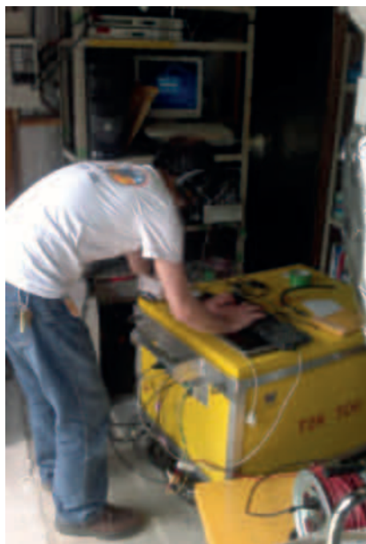
Mobilny zegar atomowy podłączony do systemu znacznika czasu w detektorze Super-Kamiokande.
