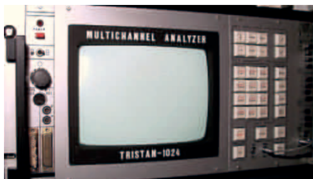
Analizator wielokanałowy TRISTAN, zaprojektowany w IR (po Czarnobylu), produkowany w ZZUJ POLON; wykorzystywany w stacjach Sanepidu do monitorowania skażeń promieniotwórczych
