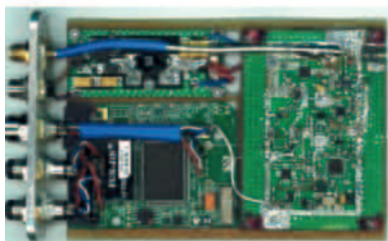
Konwerter 2.4-3.5 GHz dla sieci radiowych, wersja mobilna (opracowanie z lat 2009-2012)
