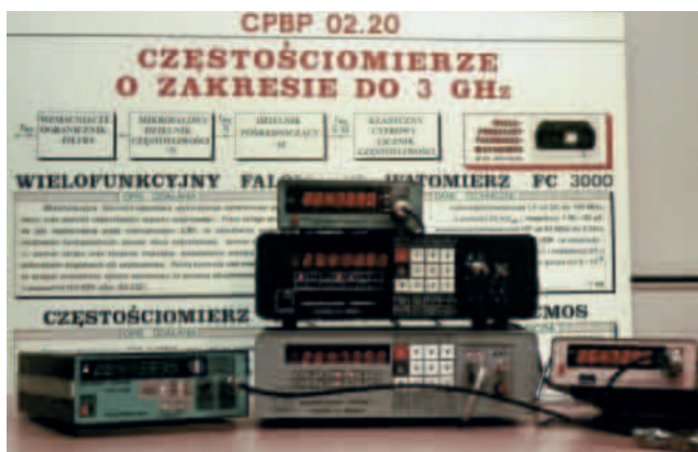
Zestaw częstotściomierzy i częstotściomierzy-watomierzy mikrofalowych opracowanych w latach 1986-1990
