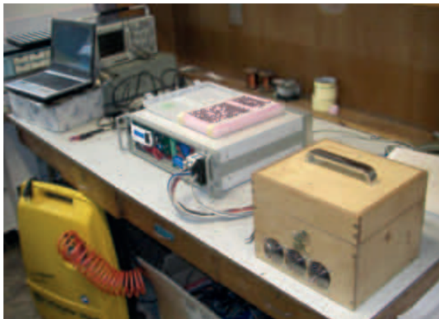
Stanowisko do automatycznego testowania i charakteryzacji detektorów MPPC dla detektora SMRD w eksperymencie T2K.
