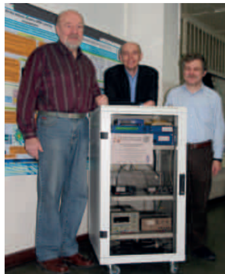
Eksperymentalny nadajnik radia cyfrowego w standardzie DRM (Digital Radio Mondiale) pracujący w paśmie HF (26 MHz) z mocą wyjściową 30 W, (2010); od lewej: Juliusz Modzelewski, Krzysztof Kurek, Wojciech Kazubski
