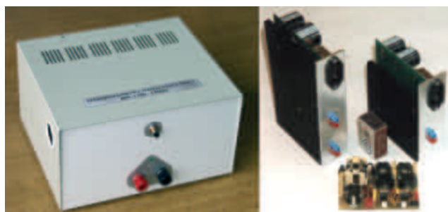
Z lewej: Szerokopasmowy liniowy wzmacniacz mocy 40 W (2001). Z prawej: wysokosprawne zasilacze z przetwornicami rezonansowymi klasy DE (2000)
