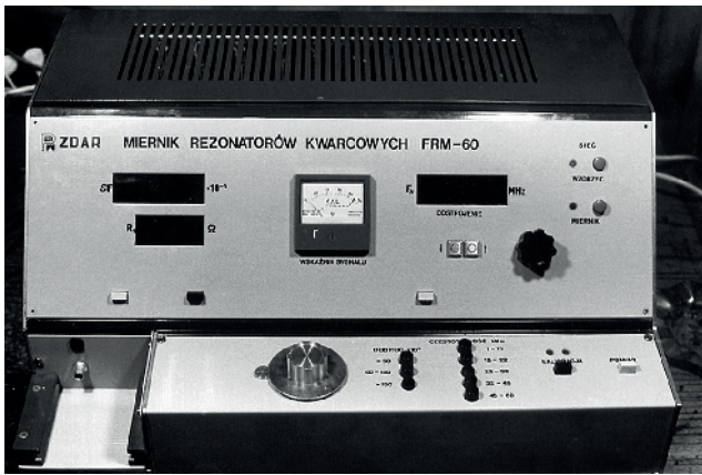
Przykład urządzenia opracowanego w zespole Adama Fioka i wdrożonego w ZDAR – miernik parametrów rezonatorów kwarcowych (1977)
