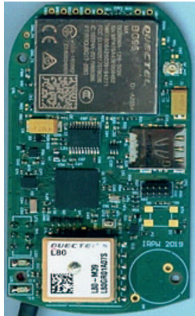
Zmontowana płytko lokalizatora opracowanego w ramach projektu INCARE
