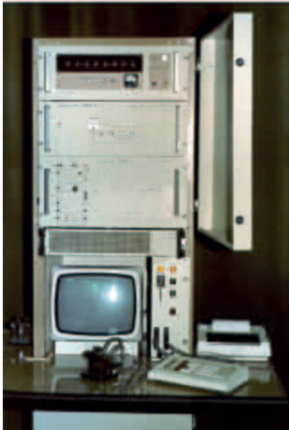
Systemy do produkcyjnych pomiarów rezonatorów kwarcowych: FRMS-125 (1983) i CMS-3 (1986)
