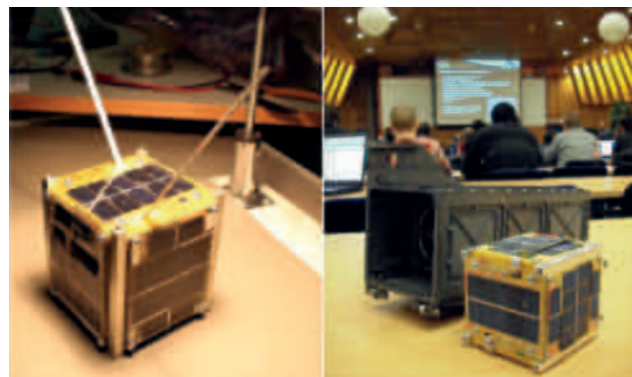
Model inżynierski piko-satelity 1 st STEP ( Space Technology Demonstration Probe ) opracowanego w IRTM w ramach prac studentów nad projektem satelity PW-Sat, 2008. Prezentacja modelu na VEGA CubeSats Workshop (ESTEC, Holandia, 2009).
