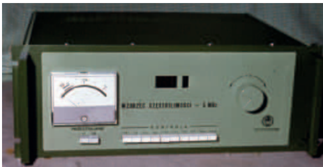
Kwarcowy wzorzec częstotliwości dla nadajnika radiofonicznego Warszawa I (1978)
