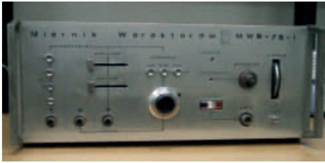
Urządzenie do pomiarów mikrofalowych diod waraktorowych (1975)
