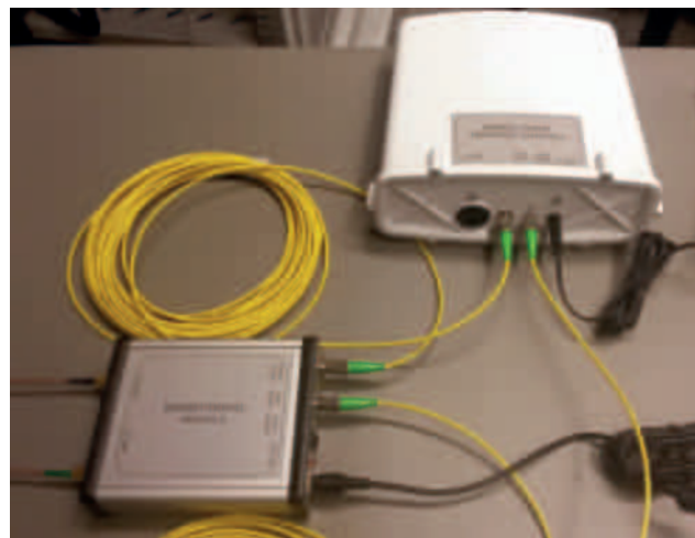
Łącze radiowo-światłowodowe z dwukierunkową anteną fotoniczną (2016)
