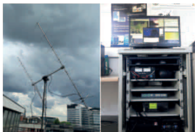
Stacja naziemna do radioamatorskich łączności satelitarnych zbudowana w IRTM, wykorzystywana m.in. do łączności z satelitą PW-Sat2
