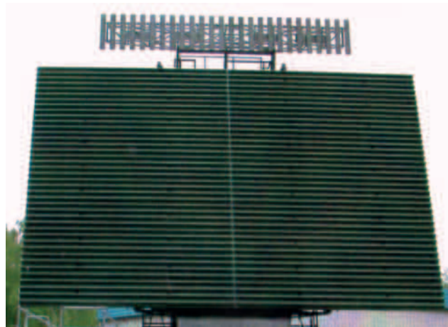
Antena trójwspółrzędnej stacji radiolokacyjnej TRD-12 (prod. PIT-RADWAR)
