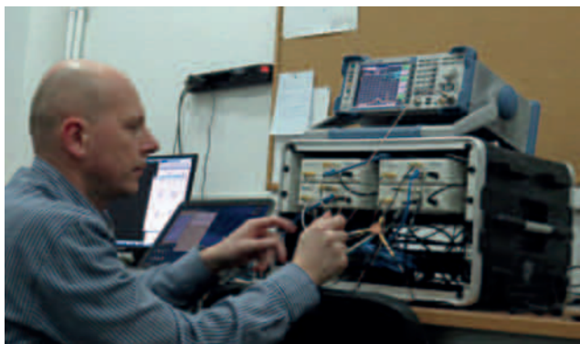
Model adaptacyjnego systemu transmisji danych z satelity na orbicie LEO zbudowany z wykorzystaniem modułów SDR (projekt SACC – Satellite Adaptive Communication Channel, ESA, 2013-2015), Krzysztof Kurek
