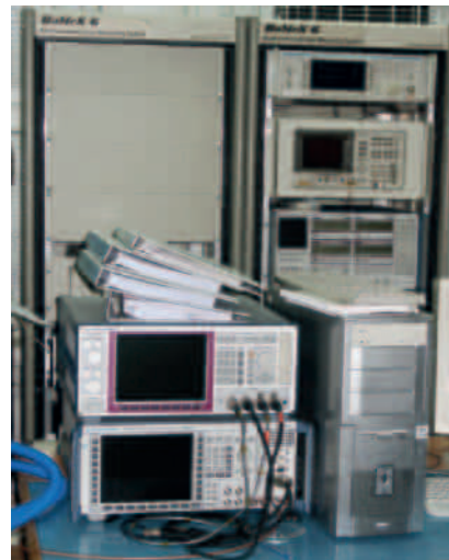
System do pomiarów urządzeń radiokomunikacyjnych RaMeS-6 – etap uruchomieniowy (1994)
