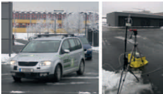
Chemnitz 2008: Badania systemu lokalizacji pojazdów (zrealizowanego w ramach programu SAFESPOT: samochód testowy i węzeł systemu lokalizacyjnego)
