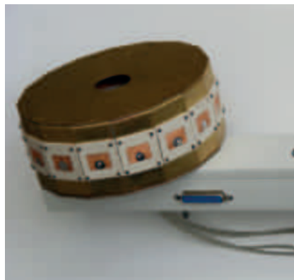
Szerokopasmowy szysk antenowy z przełączaną wiązką na częstotliwość 5,8 GHz (2008)
