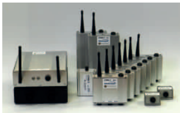
Układy wieloczujnikowego systemu do pomiarów temperatury tężącego betonu (2015)
