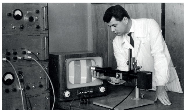
Pomiar kontrastu powierzchni ekranu na stanowisku laboratoryjnym do badań parametrów elektrooptycznych odbiorników telewizyjnych - Zdzisław Kozłowski (ok. 1965 r.)
