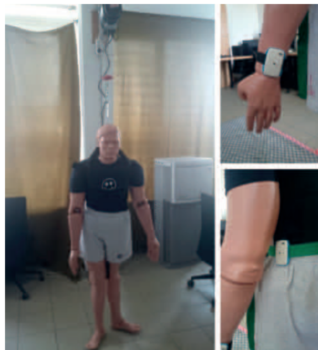
Manekin testowy na stanowisku pomiarowym (po lewej), umieszczenie etykiet z czujnikami (po prawej)
