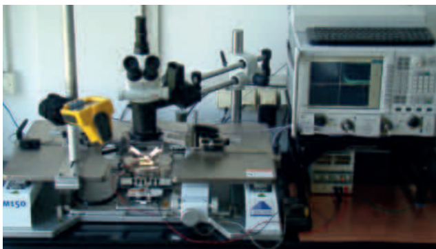
Laboratorium techniki mikrofalowej – stanowisko do pomiarów elementów „on-wafer” w pasmie do 50 GHz
