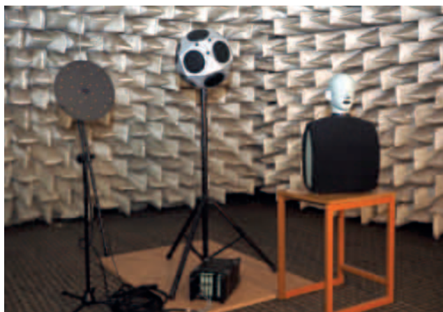
Główne elementy akustycznego systemu pomiarowego: kamera akustyczna WA1764W001 (lewo), moduł procesora Pulse 3660C100 (środek-dół), źródło wszechkierunkowe 4295 (środek-góra) manekin pomiarowy 4100 (prawo).
