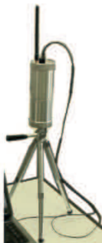
Konwerter 2.4-3.5 GHz dla sieci radiowych, wersja mobilna (opracowanie z lat 2009-2012)
