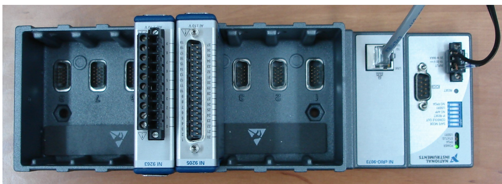
Rys. 1. Widok sterownika CompactRIO z modułami A/C i C/A.
