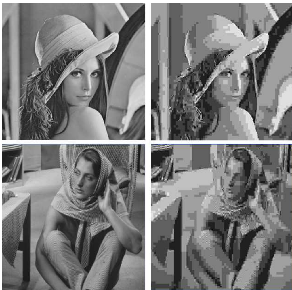
Rysunek 5.3: Efekt blokowy uzyskany dla kompresji JPEG w stopniu 43:1 (para obrazów u góry – z lewej oryginał Lena) oraz 75:1 (dolna para obrazów Barbara).
