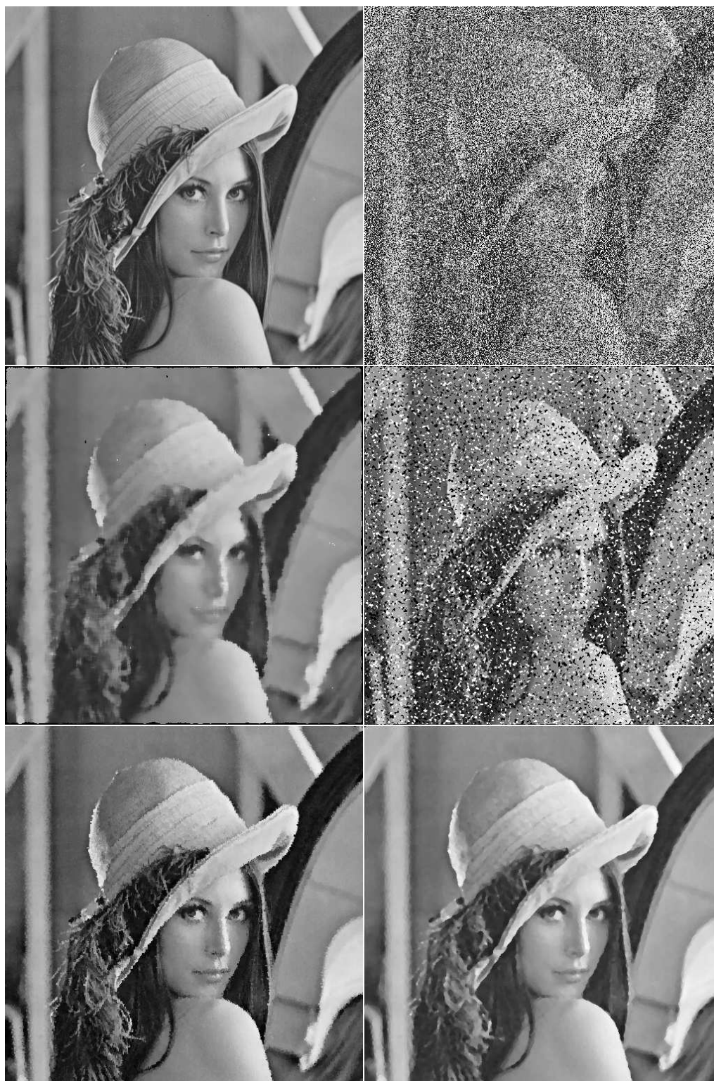
Rysunek 3.18: Przykładowe efekty stosowania filtrów nieliniowych; kolejno od lewej do prawej, góra-dół – obraz źródłowy lena, lena silnie pokryta szumem impulsowym ("sól i pieprz"), odszumienie za pomocą filtru medianowego o dużej masce 9 \times 9 z silnym rozmyciem obrazu, nieskuteczność filtru medianowego o mniejszej masce 3 \times 3 , wykorzystanie selektywnego filtru modalnego zawężającego zakres wartości użytecznych, zastosowanie kaskady filtrów modalnego 2 \times 2 z selekcją oraz medianowego 5 \times 5 .
