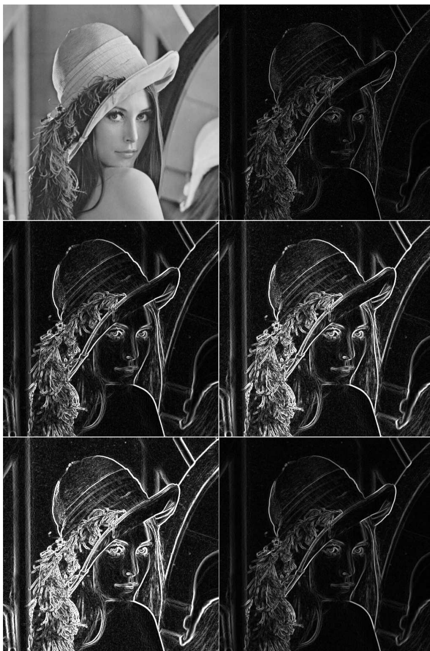
Rysunek 3.15: Efekty splotowej filtracji służącej detekcji krawędzi (filtry gradientowe); kolejno od lewej do prawej, góra-dół – obraz źródłowy lena, po filtracji różnicowej (3.25), Prewitta (3.27), Sobela (3.28), Sobela z dodatkowymi filtrami diagonalnymi (3.30), Kirscha (3.32).
