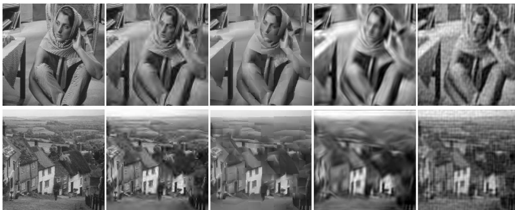
Rysunek 2.1: Efekty opisu dwóch obrazów testowych (barbara i goldhill) za pomocą upakowanej reprezentacji; od lewej kolejno obrazy źródłowe o rozmiarze 512 \times 512 \times 8 bitów oraz ich przybliżenia z 13,6% współczynników obrazów, uzyskanych za pomocą bazy falkowej, wedgetowej (kliników), curveletowej (krzywek) oraz fourierowskiej.
