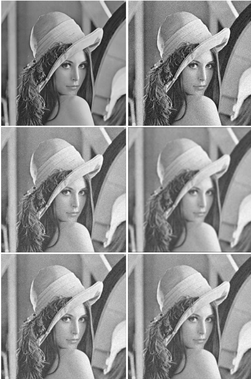
Rysunek 3.11: Efekty odszumiania za pomocą liniowej filtracji splotowej; kolejno od lewej do prawej, góra-dół – obraz źródłowy lena, lena z równomiernym szumem addytywnym o amplitudzie 50 (średniokwadratowa różnica względem oryginału wynosi mse = 831 ) oraz obraz ten przekształcony za pomocą, kolejno (patrz definicje (3.20)), równomiernego filtru uśredniającego 3 \times 3 ( mse = 675 ), równomiernego filtru uśredniającego 7 \times 7 ( mse = 746 ), filtru parametrycznego dla p = 2 ( mse = 669 ) oraz filtru gaussowskiego z \sigma = 1 ( mse = 668 ).
