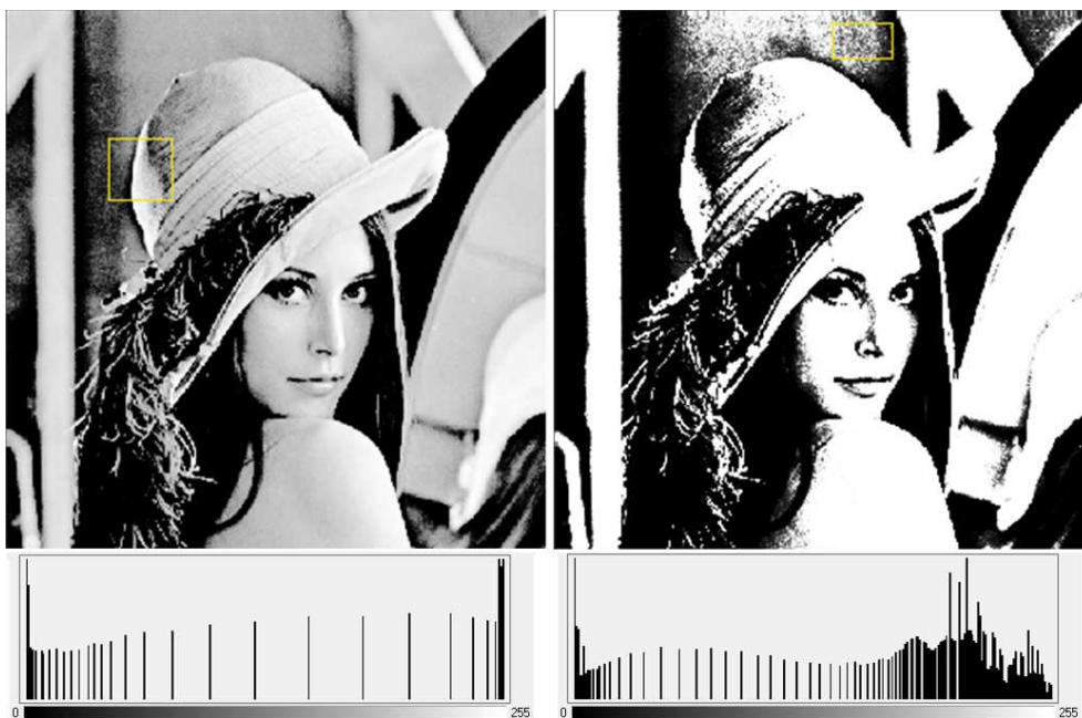
Rysunek 3.10: Efekt wyrównania histogramu obrazu testowego lena na podstawie lokalnego histogramu z obszaru wskazanego prostokątem – pod ulepszanymi (choć niekoniecznie ulepszonymi) obrazami zamieszczono ich przekształcone histogramy (w stosunku do źródłowego histogramu z rys. 3.5).
