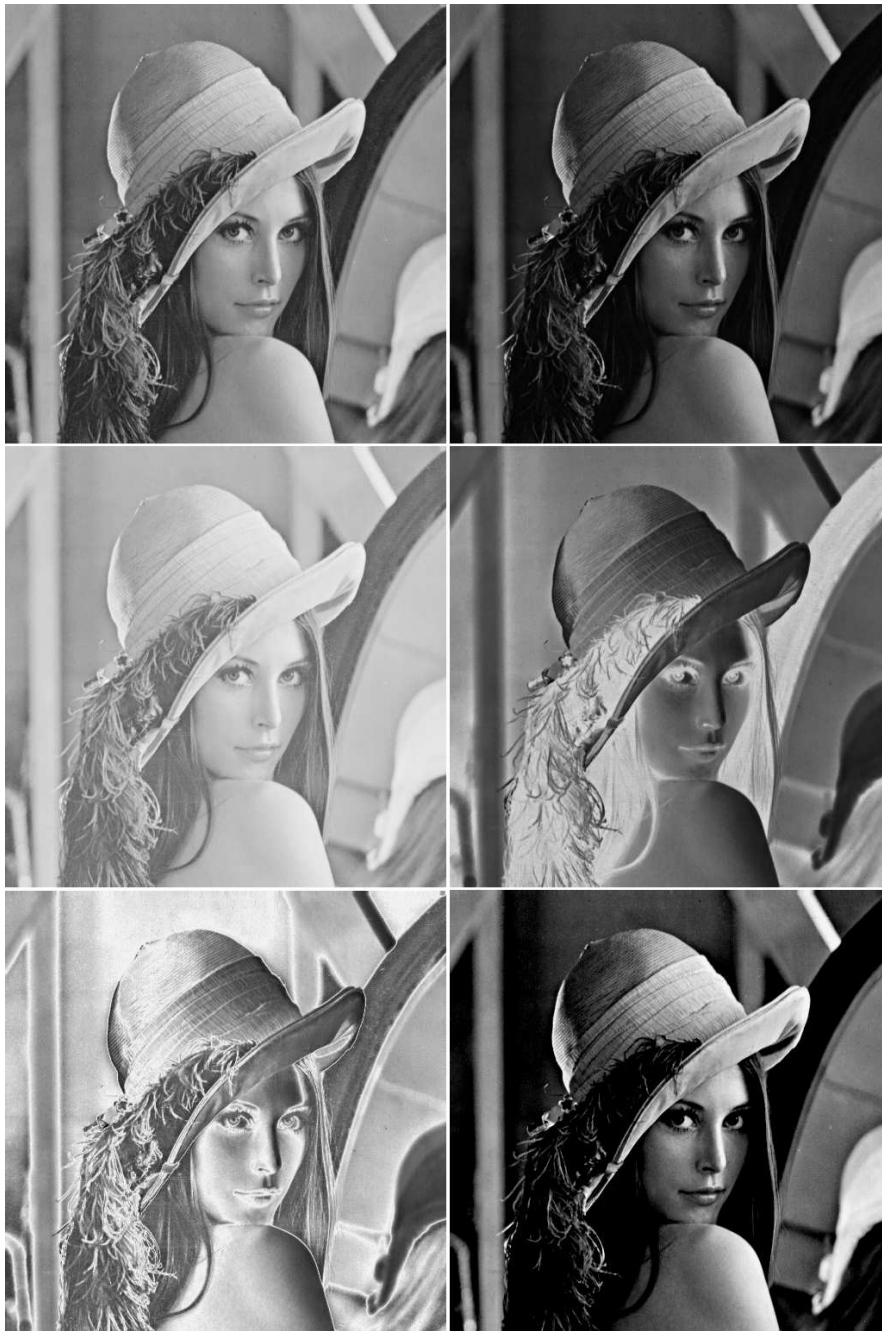
Rysunek 3.1: Przykładowe efekty regulacji kontrastu i jasności obrazów z wykorzystaniem przekształceń punktowych; w porządku od lewej do prawej, góra-dół mamy kolejno obraz źródłowy, korekcję gamma \gamma = 2, 2 , korekcję gamma \gamma = 1/2, 2 , negatyw, solaryzację oraz funkcję okna ustawioną na zakres d = 0, 4 , g = 0, 9 znormalizowanej dynamiki (okno tak dobrano, by uwidocznić szczegóły twarzy poprzez poprawę kontrastu).
