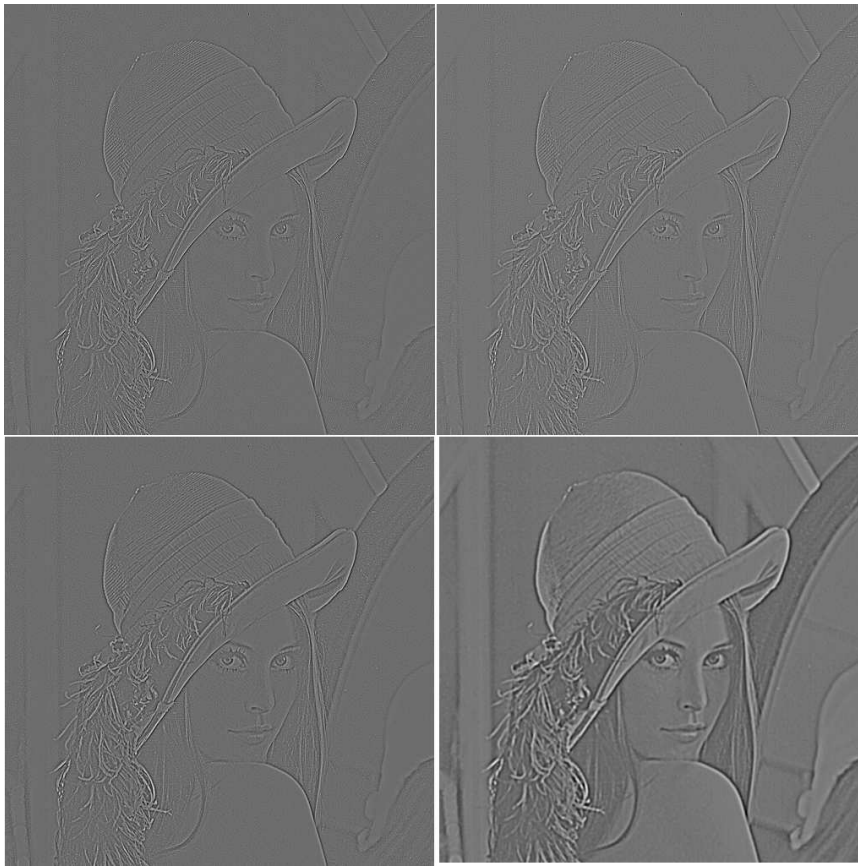
Rysunek 3.16: Efekty splotowej filtracji służącej detekcji krawędzi (laplasjan); kolejno od lewej do prawej, góra-dół – obraz źródłowy lena po filtracji laplasjanowej według (3.34) oraz według (3.35) z wartością centralną 8, po filtracji LoG 5 \times 5 według (3.36) oraz LoG 9 \times 9 (3.37).
