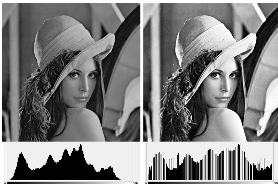
Rysunek 3.5: Efekt wyrównywania histogramu obrazu testowego lena – po lewej obraz źródłowy z histogramem, po prawej - obraz z ulepszonym kontrastem wskutek wyrównywania histogramu.
